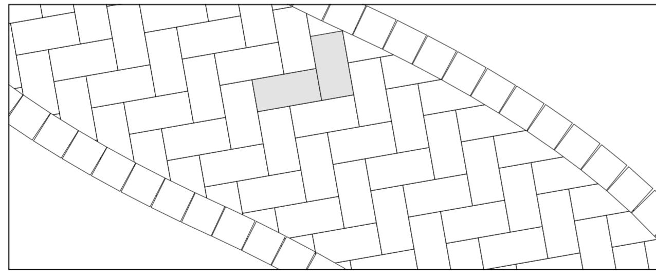
Composizione vialetto con Elemento L al bordo - Walkway with L-shaped element at the edge
